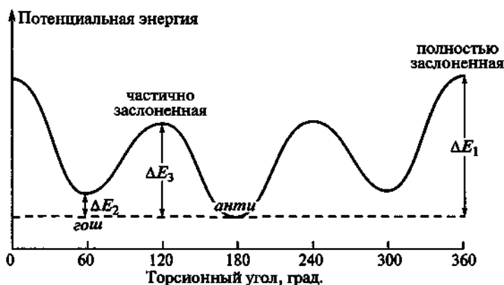
Рис. 4.5. Диаграмма потенциальной энергии конформаций систем \text{YCH}_2\text{—CH}_2\text{Y} или \text{YCH}_2\text{—CH}_2\text{X} . Для n -бутана \Delta E_1 = 4\text{--}6 , \Delta E_2 = 0,9 и \Delta E_3 = 3,4 ккал/моль (17–25, 3,8 и 14 кДж/моль соответственно)
