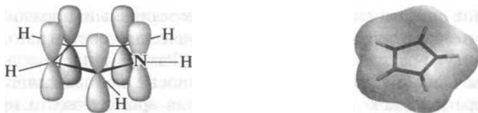
Рис. 2.8. Перекрывание пяти p -орбиталей в пирроле и карта электронных потенциалов для пиррола
